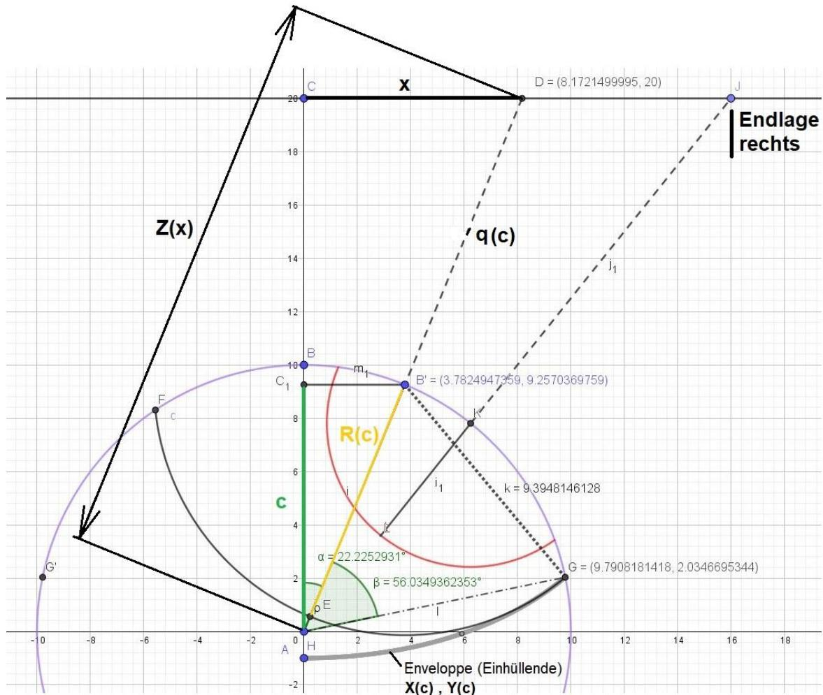
Zuerst sind für die Konstruktion einige wichtige Punkte und Längen zu bestimmen, mit denen später auch weitergerechnet wird. Dazu zählen die Punkte B' und G, mit denen die Enveloppe im Innern des Kreises startet. Die Enveloppe endet dann im Punkt H.
